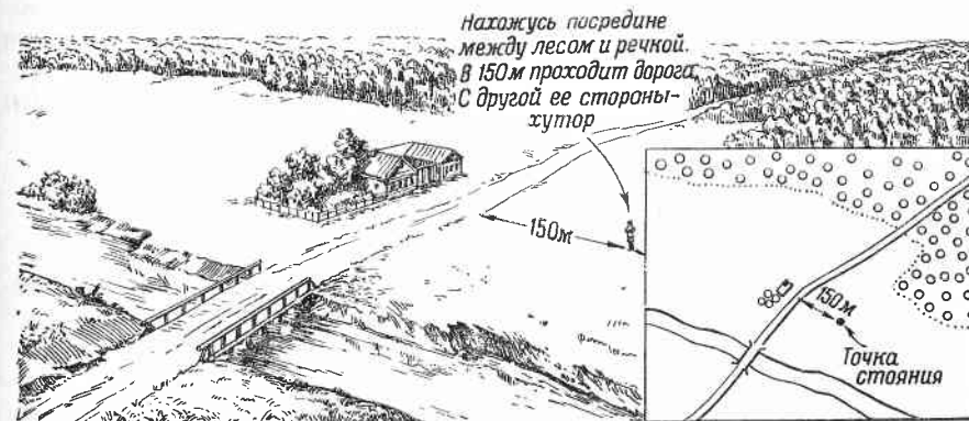
Рис. 126. Определение точки стояния по местным предметам
