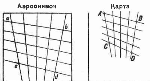
Рис. 117. Построение соответственных сеток на аэроснимке и карте
