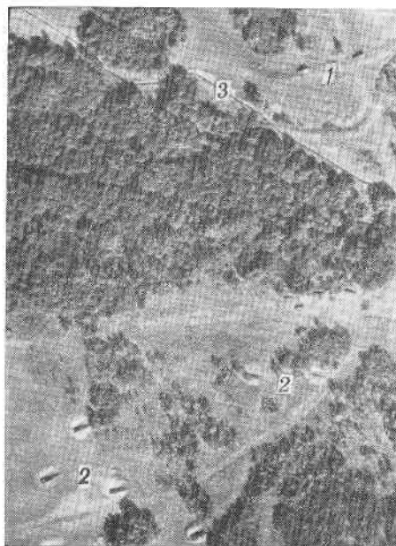
Фото 38. Масштаб 1:4500: 1 — автомашины, 2 — укрытия для автомашин; 3 — траншея
