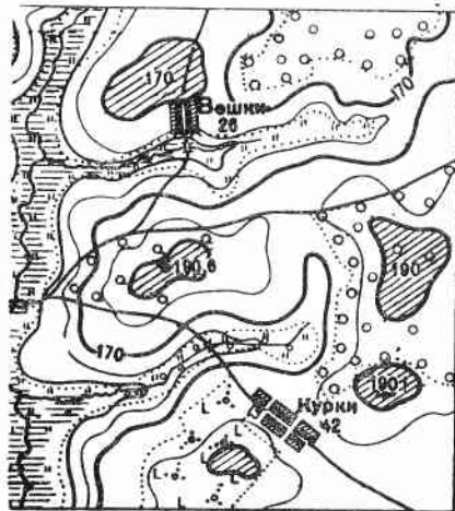
Рис. 121. Подъем рельефа оттенением горизонталей
