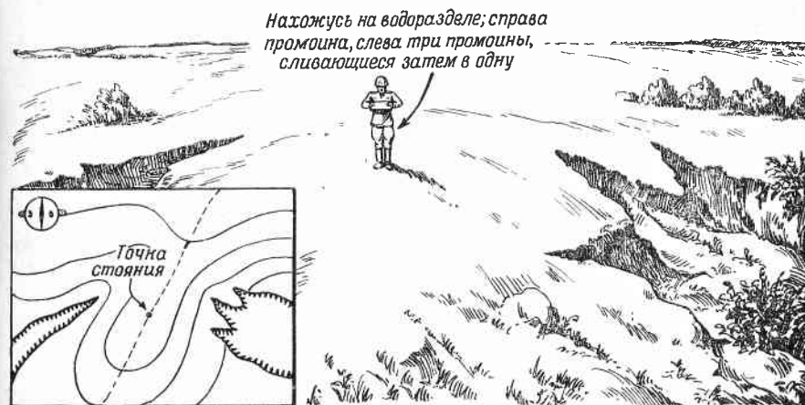
Рис. 127. Определение точки стояния по рельефу
