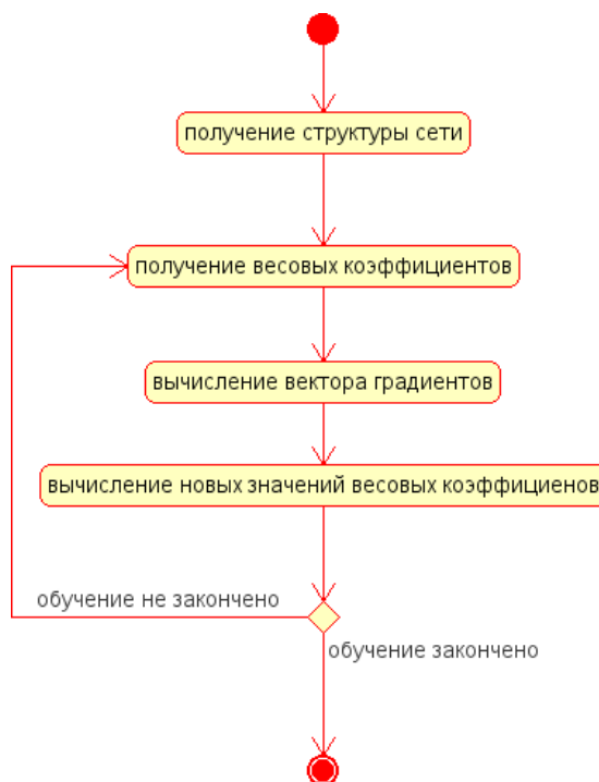
Рисунок 2. Диаграмма действий вычислительного узла при подборе значений весовых коэффициентов градиентным методом
