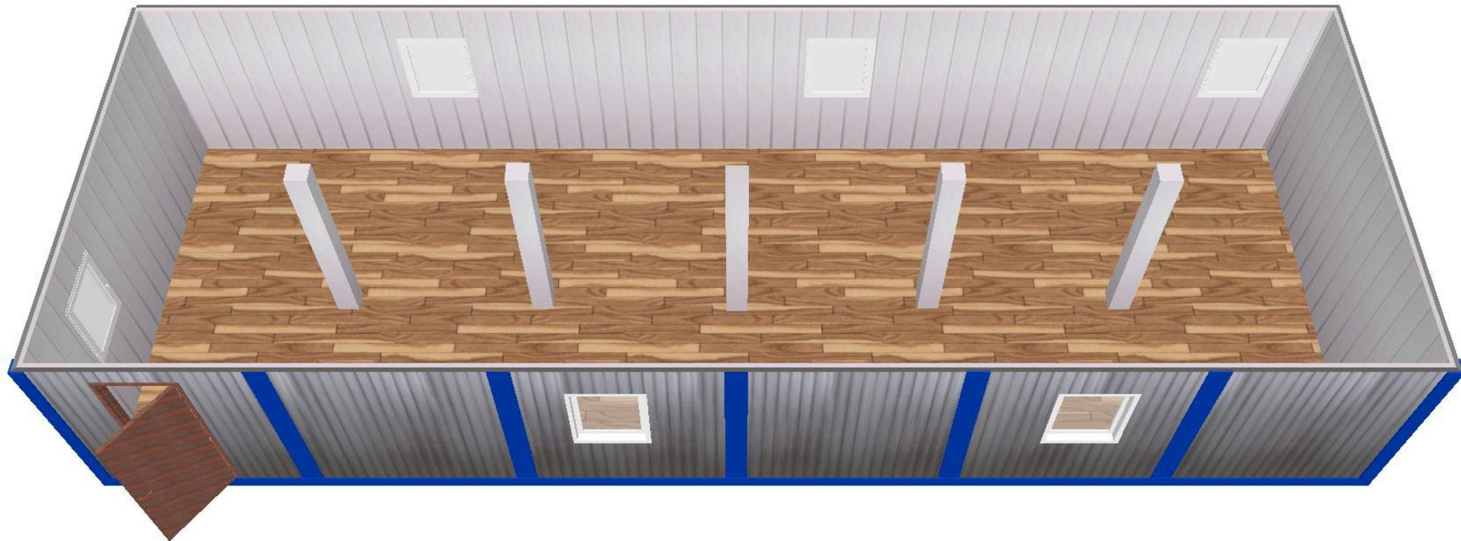
**Длина блок-модуля — 14,4м.,    Ширина блок-модуля — 5,0м.,    Высота блок-модуля — 2,5м.**
