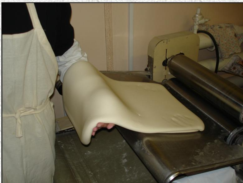
Затем на раскаточной машине делают необходимый зазор между валами (для нижней части малой просфоры – 16–18 мм, для верхней – 10–12 мм). Прокатывают тесто и штангельциркулем измеряют толщину теста.
