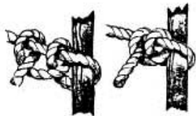
ШТЫК. Этот узел часто употребляется для прикрепления веревки к колышкам. Легко регулируется.
