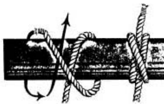
ВЫБЛЕНОК. Употребление: привязать лодку, привязать веревку к дереву или посоху. Узел верный и очень легко развязывающийся.
